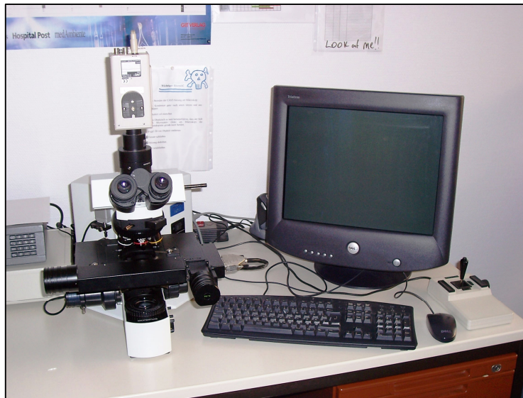
Abbildung 9: Olympus BX 51 Lichtmikroskop mit Computerbildschirm zur computerassistenten stereologischen Auswertung
