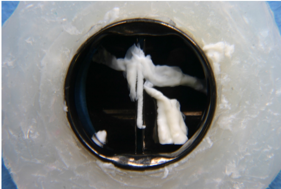
Abbildung 3. 10 On-X®-Herzklappenprothese. Zweiter Versuchsdurchlauf, Ergebnis nach 22 min. Aufsicht von ventrikelseitig mit an den Öffnungsflächen der Flügel anhaftendem Thrombus. Foto: C. Stephan
