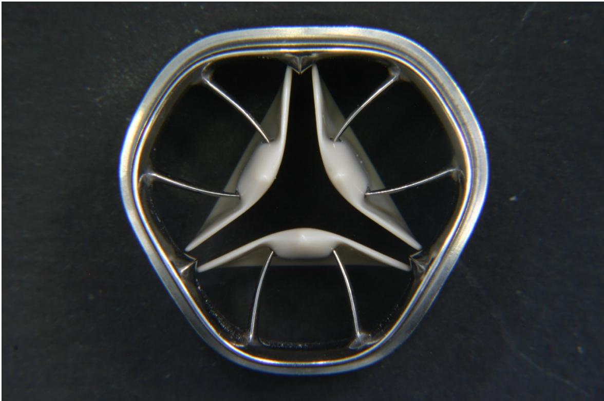
Abbildung 2. 4 Neu entwickelte Dreiflügel-Aortenklappenprothese (novel tri-leaflet mechanical heart valve prosthesis) von ventrikelseitig, Flügel geöffnet. Foto: C. Stephan
