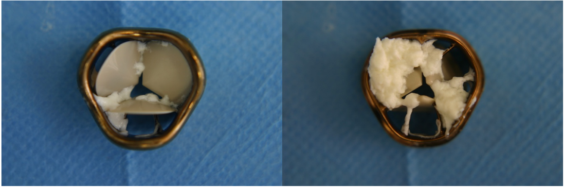
Abbildung 7. 4 Dreiflügel-Aortenklappenprothese mit eingeschwemmten Artefakt-GerinnseIn (Fotos: C. Stephan)
