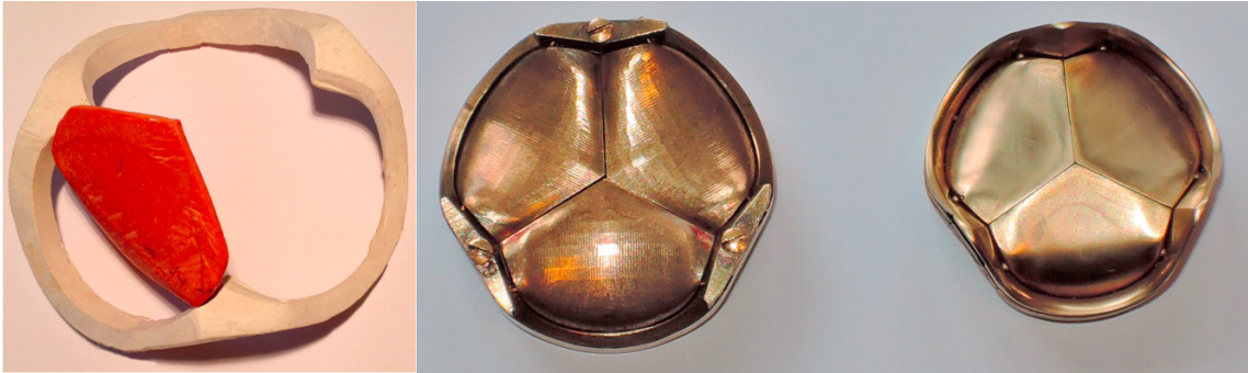
Abbildung 1. 4 Erstes Modell aus gehärtetem Knetgummi (links); Erste 1:1 - Modelle aus Messing (rechts) (13). Fotos: Prof. Dr. med. H. - H. Sievers
