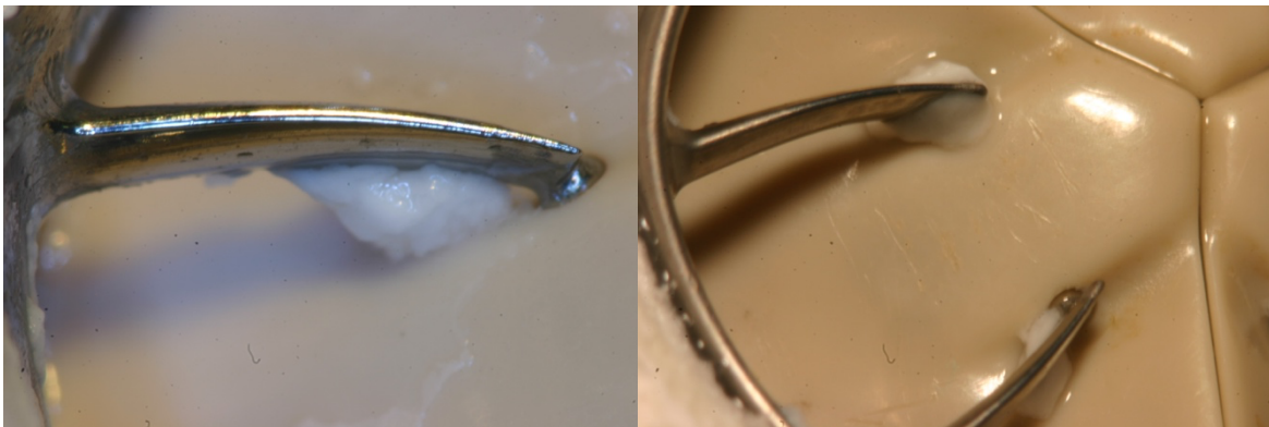
Abbildung 3. 3 links: anhaftender Milchthrombus an der Abstromseite der Strebe (BS) der neu entwickelten Dreiflügel-Aortenklappenprothese, rechts: anhaftender Milchthrombus am Gelenkmechanismus HLL und HML. Fotos: C. Stephan
