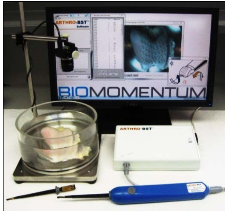
Abbildung 2 Übersichtsbild des Arthro-BST™ Versuchsaufbaus mit Testkammer, Kamera, Messgerät, Positions- und Auswertungssoftware. Mit freundlicher Genehmigung von Biomomentum.Inc.
