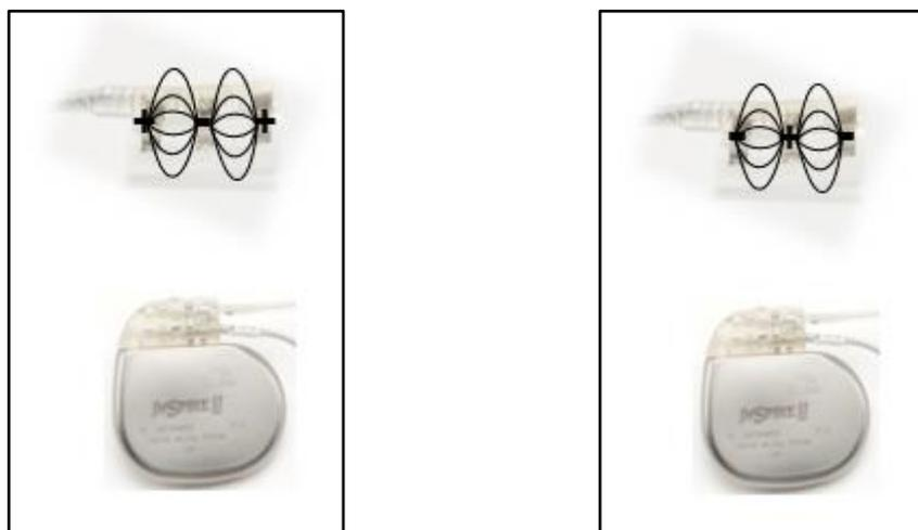
**Abbildung 9:** Darstellung der bipolaren Elektrodenkonfigurationen: [+ - +] (links), [- + -] (rechts). Die Elektroden der Stimulationselektrode bilden dabei Minus- (-) und Pluspol (+), IPG nicht involviert. (Mit freundlicher Genehmigung von Inspire Medical Systems, Inc. Minneapolis, United States of America).
