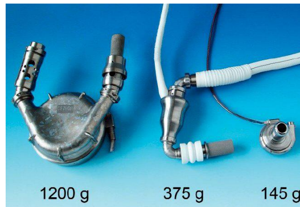
Abbildung 1.2: Erste bis dritte LVAD Generation im Größen- und Gewichtsvergleich
