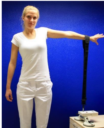
Abb. 20: Anwendung des isometrischen Dynamometers Modell Isobex ® 4.0 (Fa. MDS Medical Device Services AG, Burgdorf, Schweiz).
