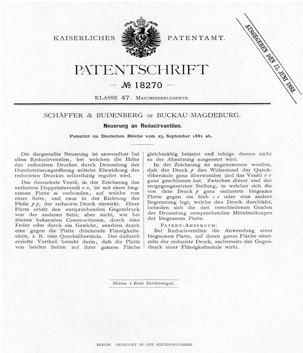
Abb. 75: Eines der ersten deutschen Druckminderungsventile von Schäffer und Budenberg aus Buckau-Magdeburg [102].
