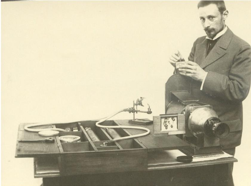
**Abb. 20: Demonstration eines Projektionsapparates mit einer Kalklichtanlage 1901 [69].**
