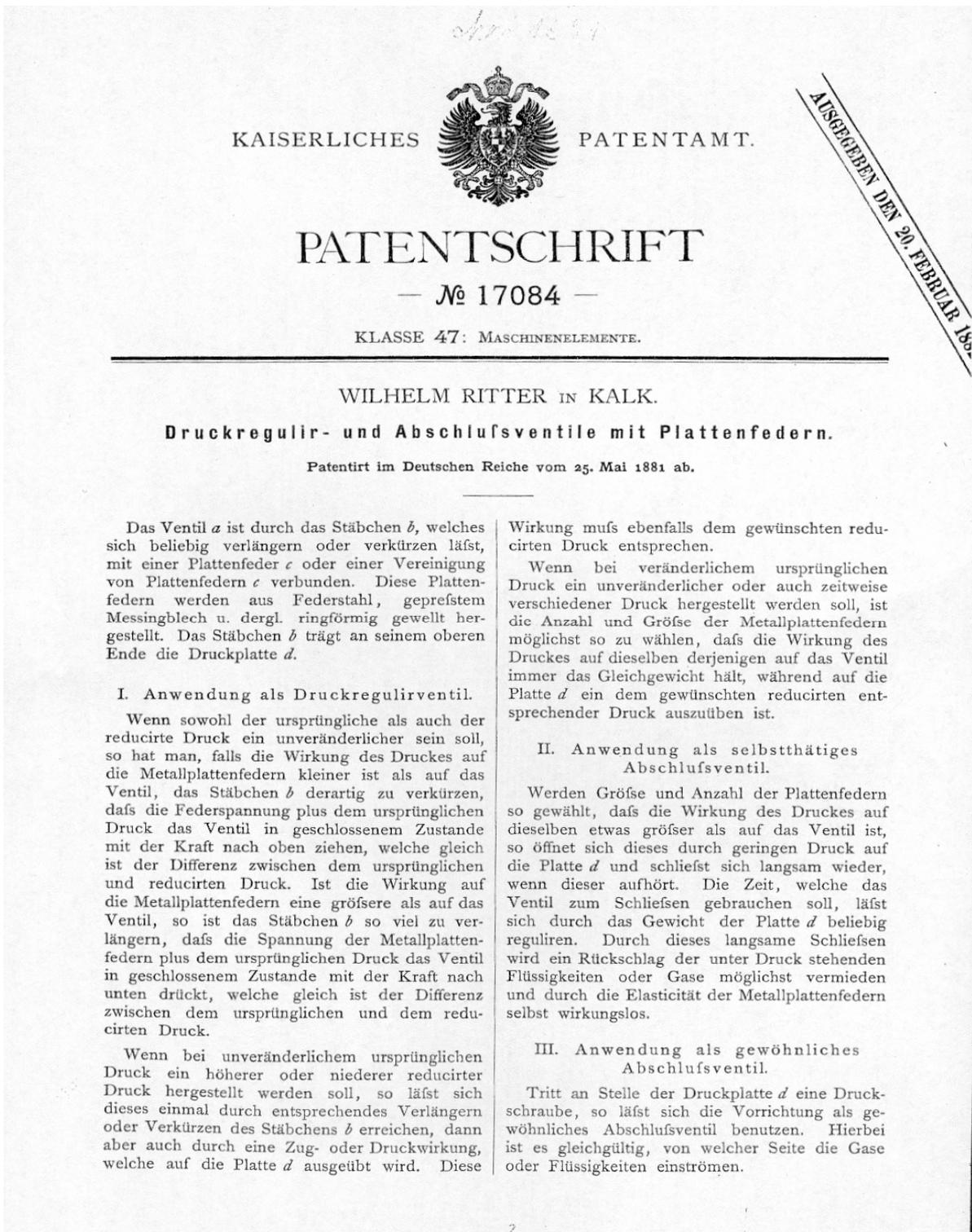
Abb. 72: Eines der ersten deutschen Druckminderungsventile von Wilhelm Ritter aus Kalk [99].
