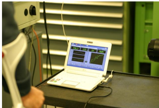
Abb. 11: Notebookcomputer mit Bluetooth Verbindung zum Lesegerät, Software zur Darstellung der Messwerte und Möglichkeit der kontinuierlichen Speicherung aller Messdaten.
