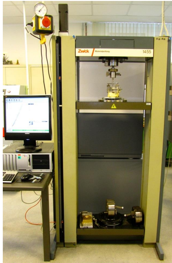
Abb. 12: Materialprüfmaschine Zwick 1455 (Zwick GmbH & Co. KG, Ulm).
