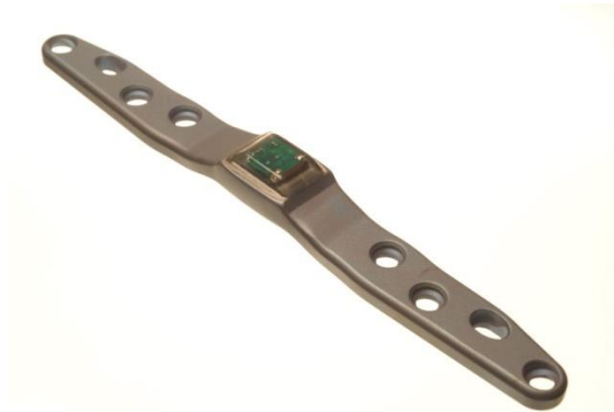
Abb. 8: Instrumentiertes Implantat mit Telemetrieelektronik.
