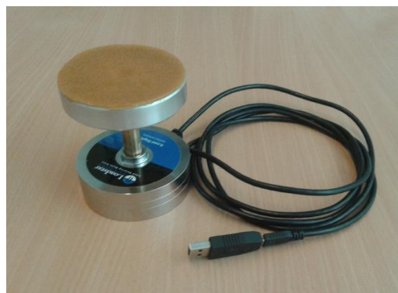
Abb. 10: Verwendeter Applikator für die externe Last (Kraftmesssensor)
