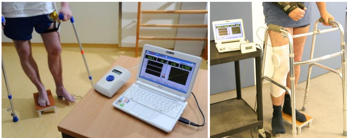
Abb. 18: Messung unter axialer Belastung in stehender Position. Das Gehäuse des Lesegerätes auf Foto a) wurde durch eine verkleinerte Version (siehe Foto b)) ersetzt, wobei die Elektronik nicht verändert wurde.
