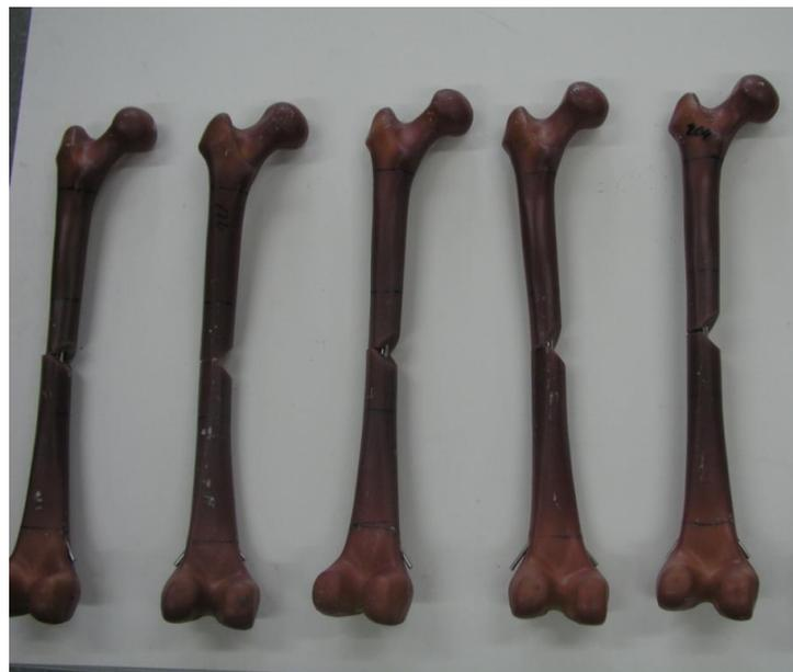
Abbildung 5: Sawbones mit hergestellter Keilfraktur, Keil medial. Hier bereits mit 2-C-ESIN-Osteosynthese.
