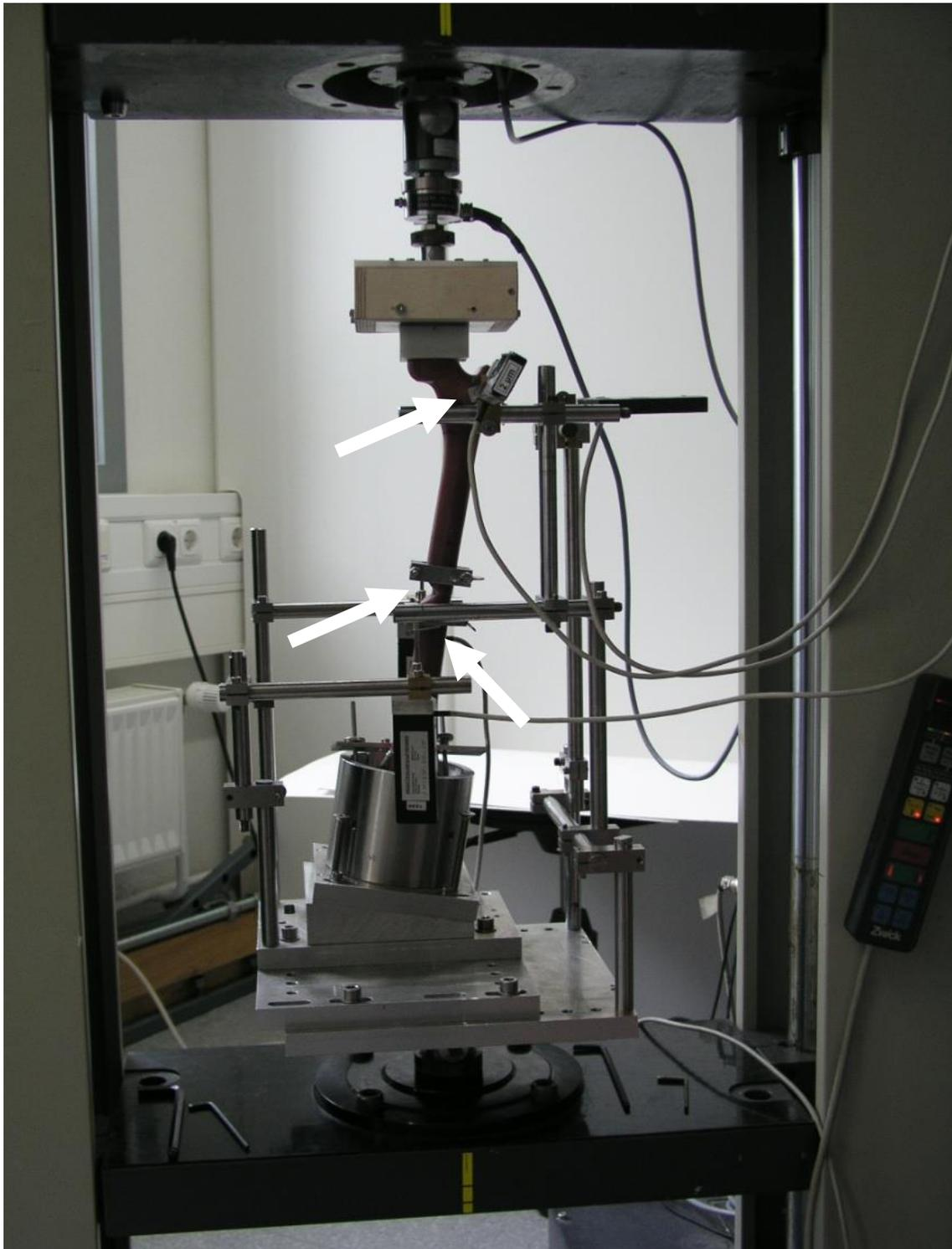
Abbildung 13a: Messaufbau zur 9°- Kompression, Pfeile: Tasterposition an den Schellenunterkanten sowie der Crista intertrochanterica
