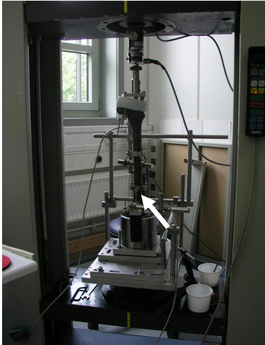
Abbildung 12: Messaufbau zur axialen Kompression, Pfeil: Tasterposition an der unteren Schelle; Taster der oberen Schelle auf der bildabgewandten Knochenseite
