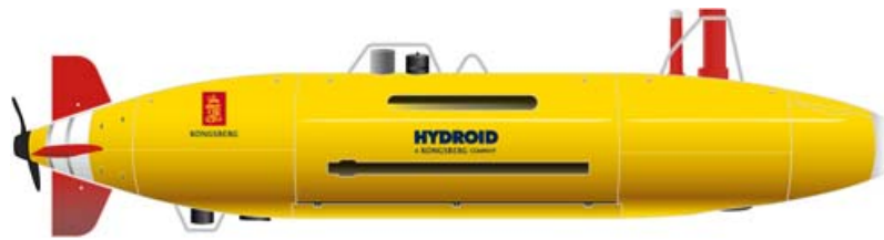
Abbildung 3.1.: Das REMUS 6000 AUV. Bild aus [Mar], mit freundlicher Genehmigung von Hydroid Inc.
