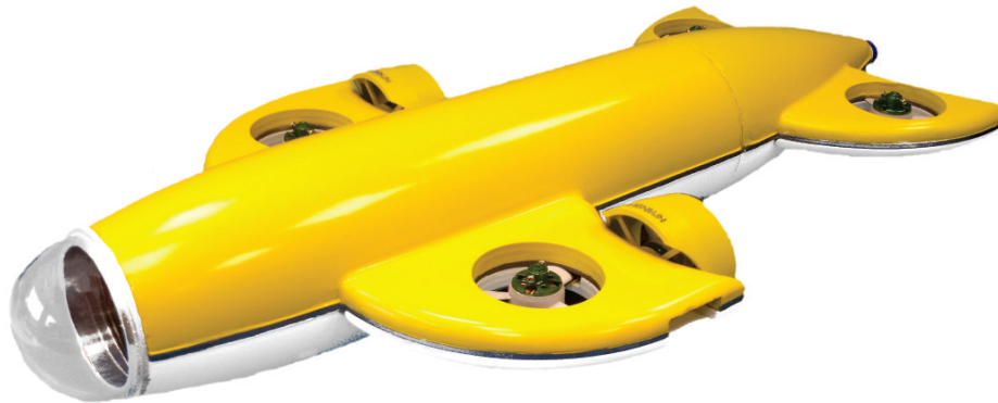
Abbildung 3.6.: Der aktuelle autonome Unterwasserroboter MONSUN [MEIM14].
